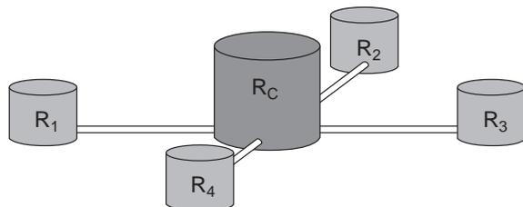
As ligações entre o reservatório central e os auxiliares são feitas por canos cilíndricos com 0,10 m de diâmetro interno e 20 m de comprimento, conectados próximos às bases de cada reservatório. Na conexão de cada um desses canos com o reservatório central há registros que liberam ou interrompem o fluxo de água.
